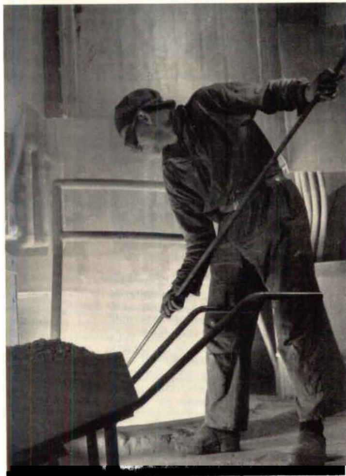
Smältare Joel Appel tar djupet i smältan. I förgrunden står en chargeringsvagn.
