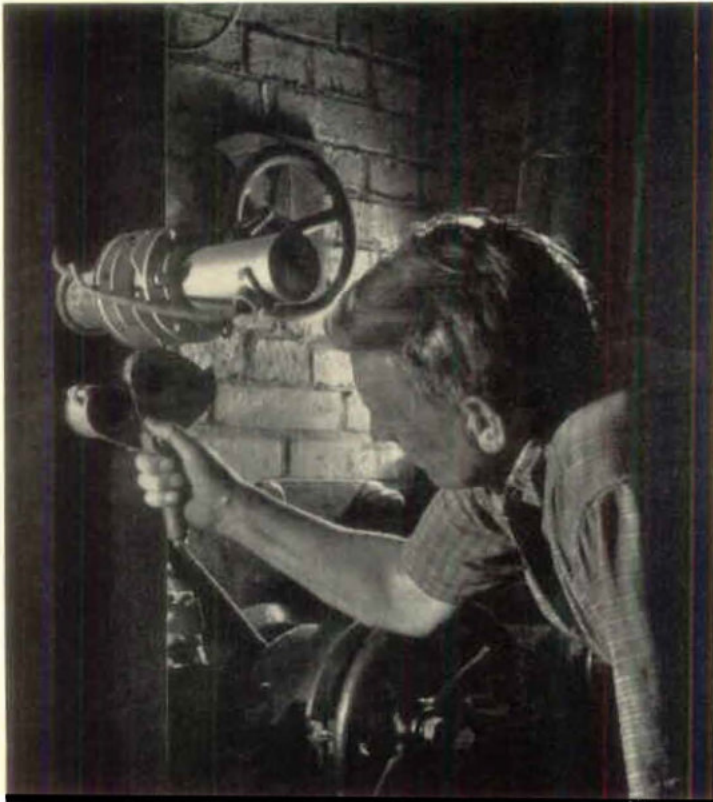
Ovan: En totalstrålningspyrometer för automatisk temperaturreglering i Bjuvs tunnelugnar. Brännare Malte Karlsson kontrollerar bottenkägglorna i ugnen. Nedan: Principritning för den automatiska temperaturregleringen.
