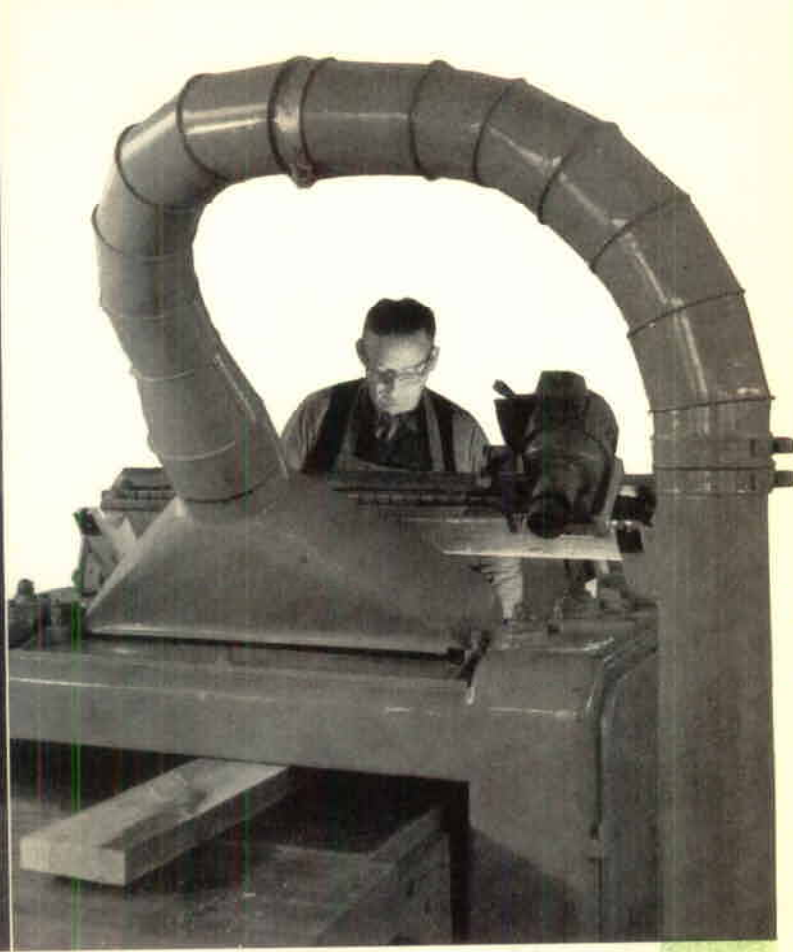
T.v.: Nils Svärd, tidigare anställd på Snickeriverkstaden i Bjuv, kapar av en klots i en av bandsågarna. Upptill på sågen syns ett bumerangliknande handtag till en bromsanordning, varmed sågen snabbt kan stoppas vid olyckstillbud. T.h.: Folke Emanuelsson, likaledes från Bjuvs snickeriverkstad, dirigerar en plankan igenom en planhyvel. Lägg märke till spånutsugningen, som befriar arbetsplatsen från spån och därmed minskar brandrisken.
