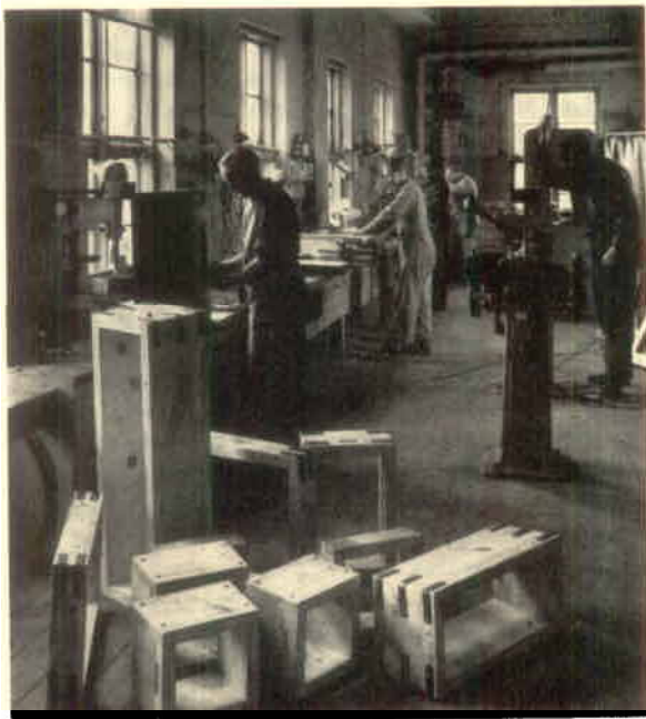
På beslagsverkstaden förses formarna med hörnbeslag, varefter registernummer och krymprocent instansas i ramen. I förgrunden ett antal ramar.
