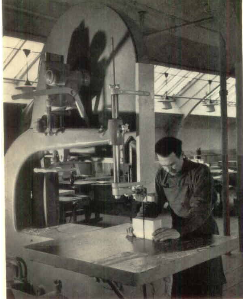
T.v.: Nils Svärd, tidigare anställd på Snickeriverkstaden i Bjuv, kapar av en klots i en av bandsågarna. Upptill på sågen syns ett bumerangliknande handtag till en bromsanordning, varmed sågen snabbt kan stoppas vid olyckstillbud. T.h.: Folke Emanuelsson, likaledes från Bjuvs snickeriverkstad, dirigerar en plankan igenom en planhyvel. Lägg märke till spånutsugningen, som befriar arbetsplatsen från spån och därmed minskar brandrisken.
