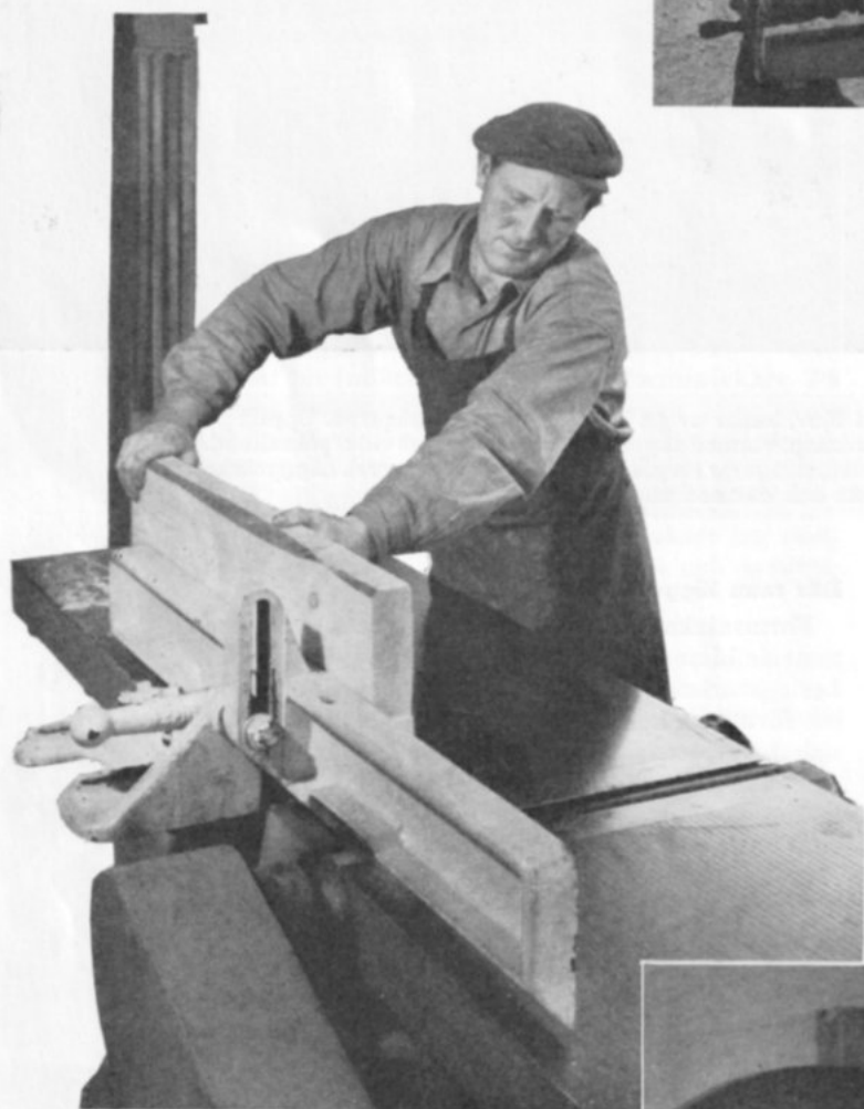
I en Wadkin överfräsmaskin utför Henry Friberg konturerna till ett forminlägg
