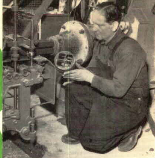
Verkstadsarbetare Charles Dahl i Bjuv med det av honom konstruerade pressmunstycket, som ger fyra strängar samtidigt
