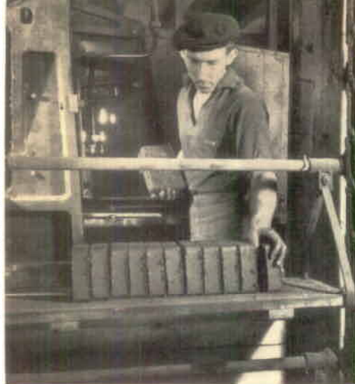
Tegelpressare Rudolf Schier på Chamottefabrikerna i Höganäs är pappa till en anordning på denna kamintegelpress, varigenom teglet kan riskfritt lyftas bort av fräntagaren
