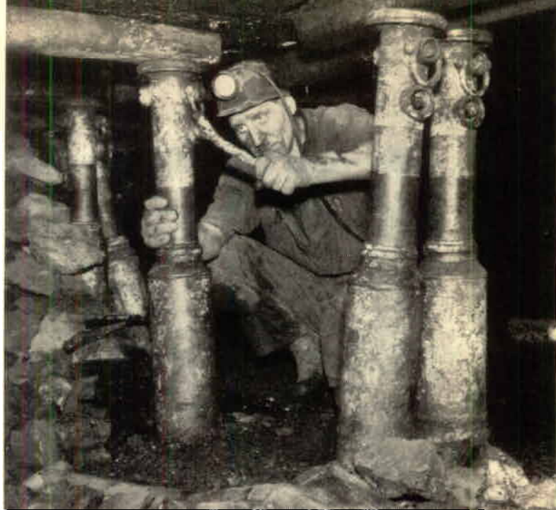
Gunnarstorps gruva har i viss mån blivit den experimentgruva, där olika nyheter på gruvfronten först prövas. Rutinerade gruvarbetaren Sigfrid Abrahamsson prövar här i ett linjebrott hydraulisk metallprops.
