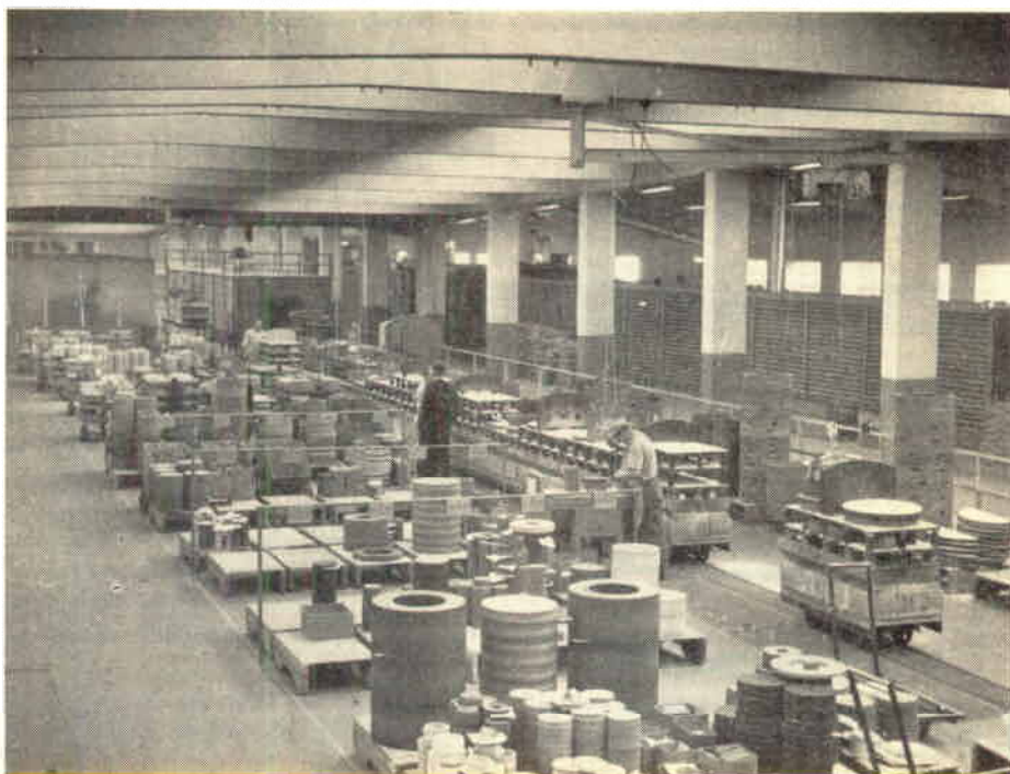
AB Slipmaterial-Naxos' anläggningar i Västervik har under senare år genomgått en omfattande rationalisering. Här en interiör från ugnsavdelningen med tunnelugn. I samma lokal sker sättning, fönning och kontroll.
