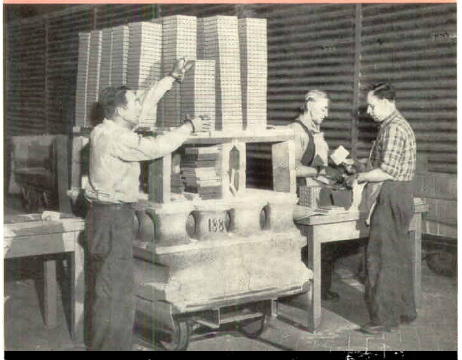
En vagn med plattor efter resan genom tunnelugnen färdig för avplockning och klyvning. Här är brandkårskompisarna Erik Kristoffersson och Erik Wiberg samt mellan dem Oskar Nilsson i färd med detta arbete.
