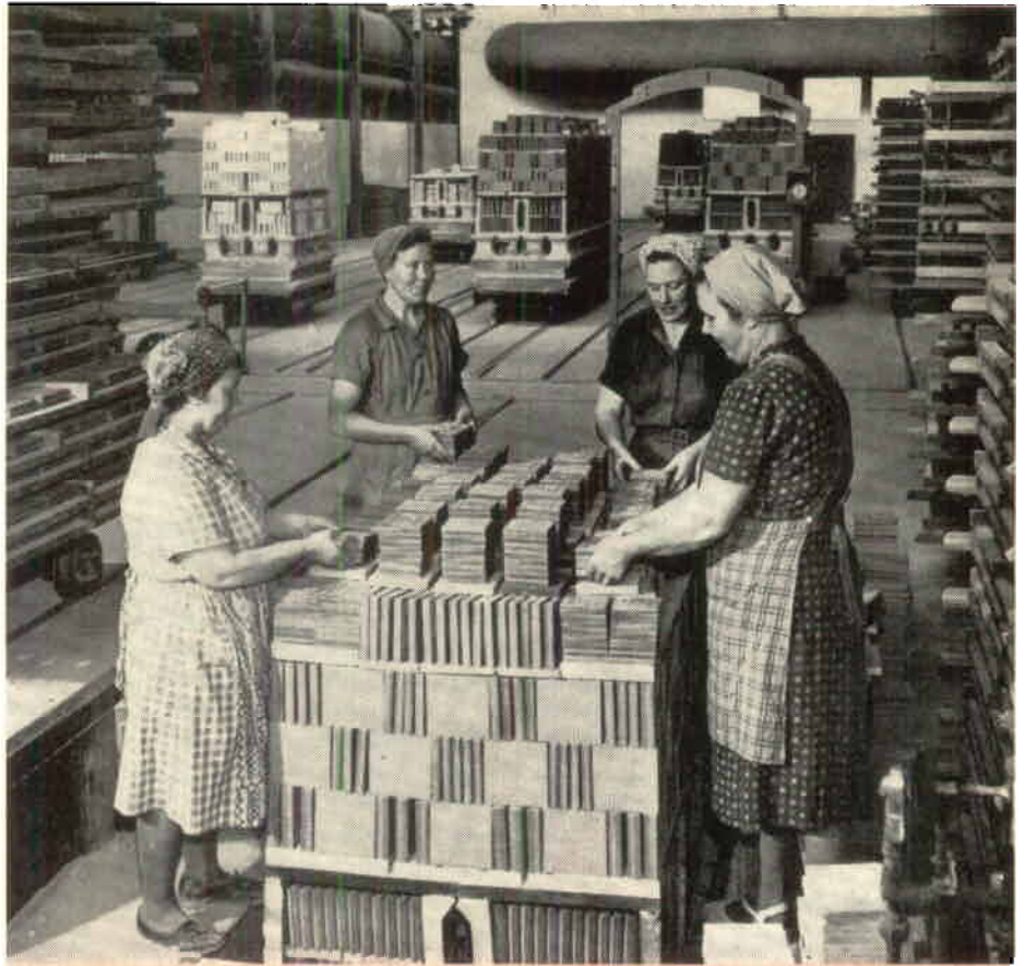
Kvinnlig arbetskraft lämpar sig synnerligen bra, när plattorna efter visst system skall sättas på tunnelugnsvagnen för bränning. Denna kvartett fruar hanterar med lätt hand de obrända och ännu så länge mycket sköra plattorna. Fr.v.: Siv Bille, Margareta Christensson, Ruth Bendroth och Anna Kärmark.
