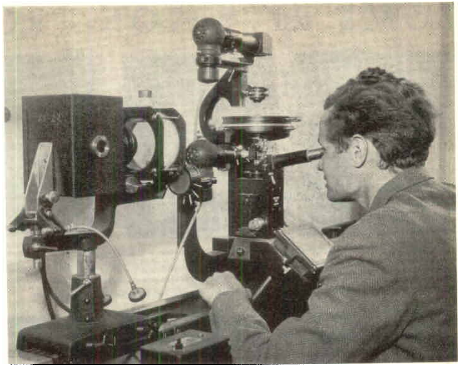
Bergsingenjör Örjan Wiberg undersöker mikroskopiskt ett polertråg av pressat och sintrat Höganäs järnpulver
