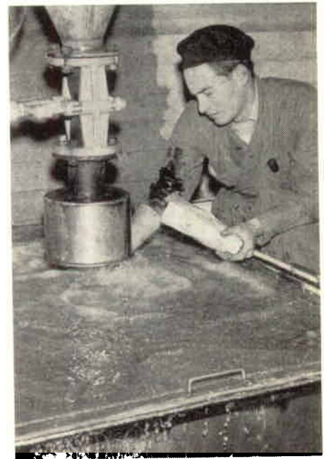
Ingenjör Rolf Jönsson tar ett prov på det färdiga atomiserade stålpulvret
