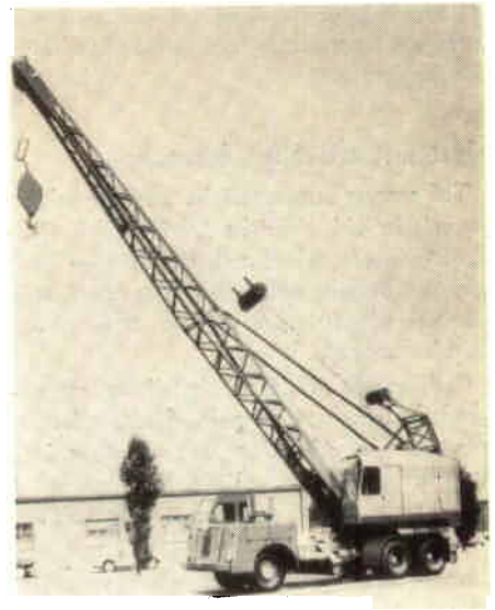
Bilburen lyftkran, typ L-65 G, tillverkad på Centralverkstaden i Höganäs.
