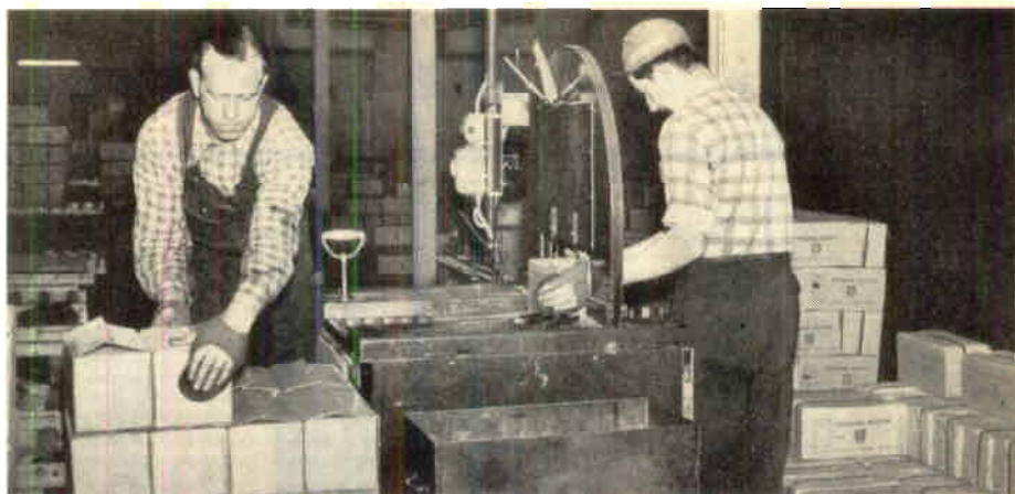
En av de nya automatiska bandningsmaskinerna i sorteringshallen vid Skrombergaverken. Bror Nilsson är maskinskötare och Bo Karlsson fråntagare.
