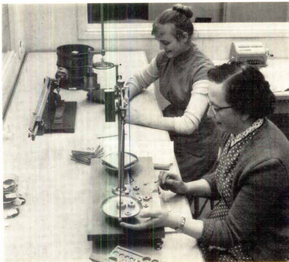
Fru Majken Svensson svarar för den löpande interna produktkontrollen i form av mätning samt vägning av de vattenmättade, kokta plattbitarna. T.h. håller Laila Nilsson på med viskositetskontroll av glasyrslamma.
