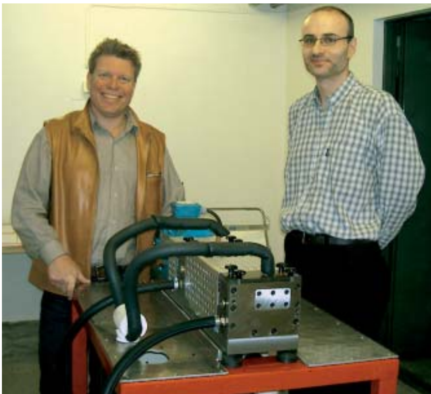
Paul Skoglund och Senad Dizdar vid den maskin Senad utvecklat för att göra slitagetester på PM-kugghjul.
