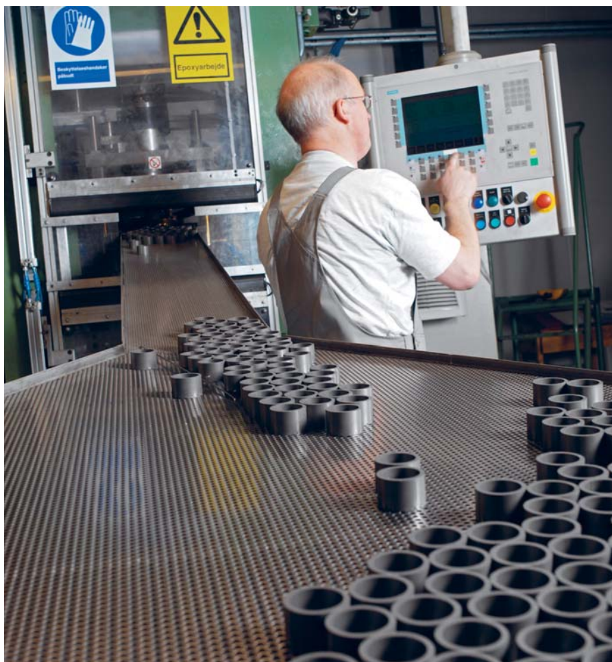
Sintex tillverkningsmetod är traditionell pulverpressning och sintring i vätgasatmosfär.
