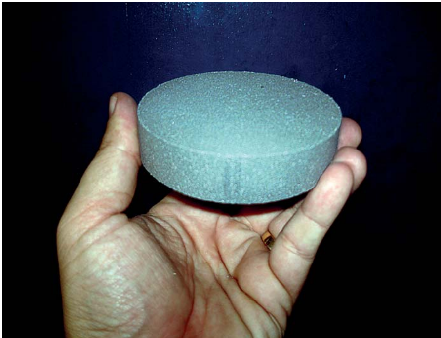
En metalltablett är cirka 10 cm i diameter och väger 650 gram. Legeringselement är bl a krom, nickel och zink. Tabletterna säljs huvudsakligen till den brasilianska stora aluminiumindustrin.
