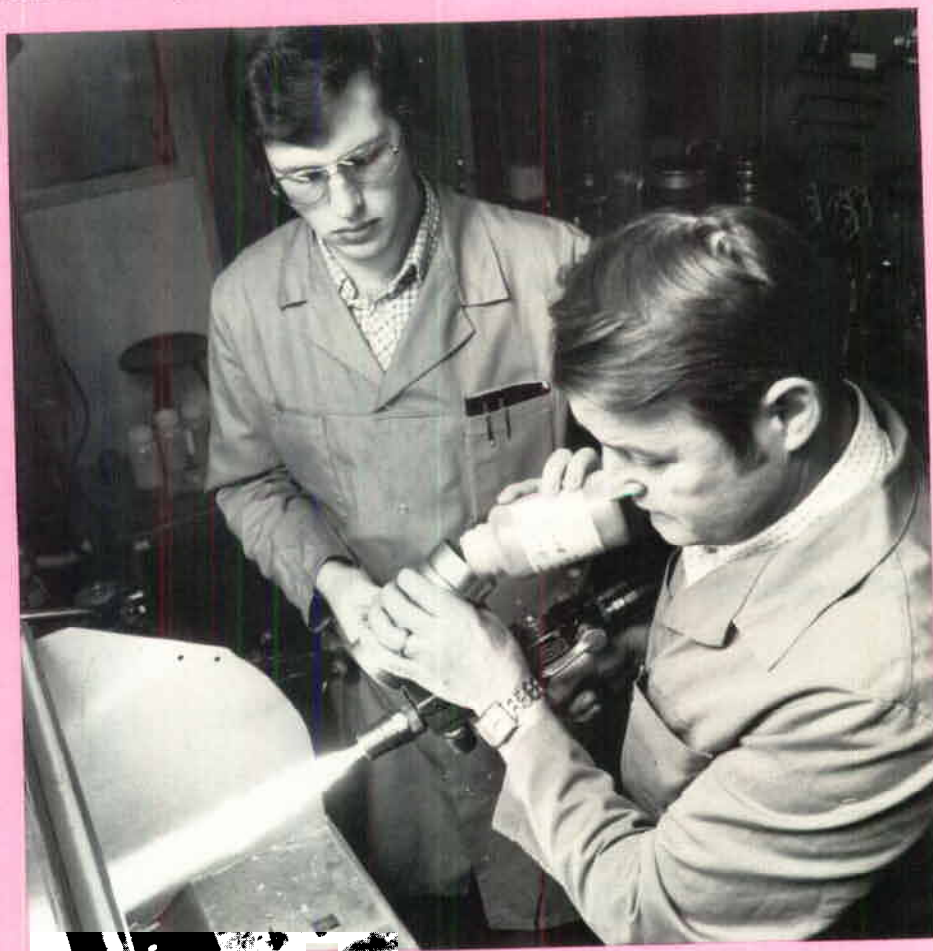
Så här går flamsprutning till! Lars-Åke Nilsson och Kurt Magnusson på Laboratorieavdelningen demonstrerar.
