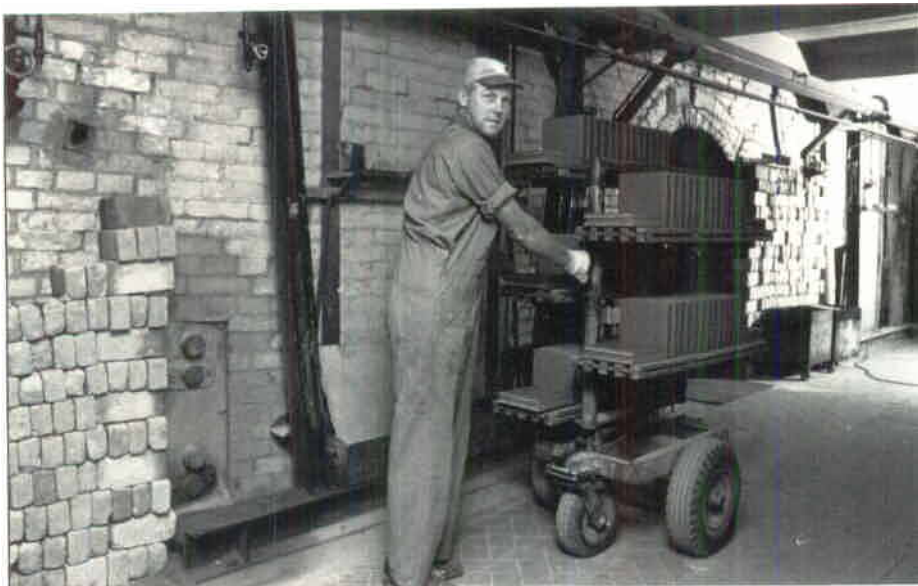
Torkade plattor transporteras till ugnen för sättnig. Mannen på bilden är Ture Lindgren.
