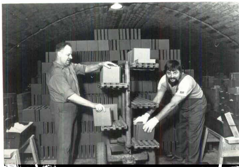
Här pågår sättnig av en av ugnens 11 kammare. Arbetet utförs av Kurt Pålsson tv och Leif Hansson.
