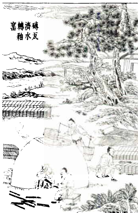
I ugnar av denna typ brändes bla tegel till den Kinesiska muren. Lägga märke till att man tillsatte vatten för att underlätta reduktionen och för att öka ugnstemperaturen.
