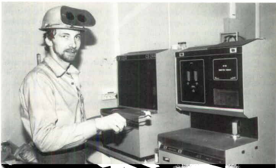
Numera går det tio gånger snabbare att få besked om förekomsten av svavel i det smälta stålet. John Bäck i provtagartagen.
