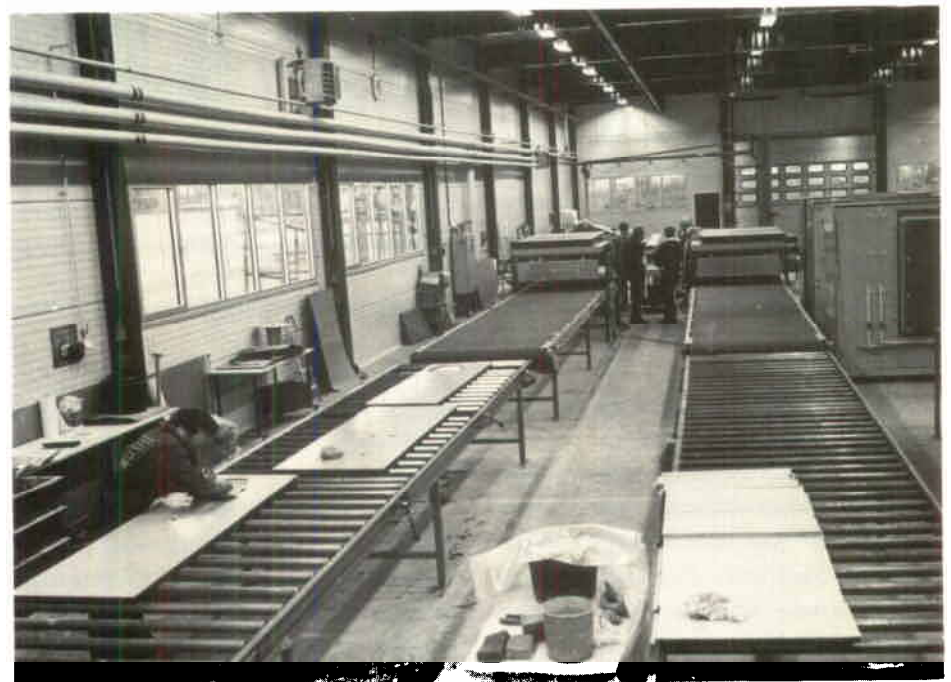
Genom att sätta och foga mosaiken på liggande väggar blev "tillverkningen" av badrummen mycket rationellare.
