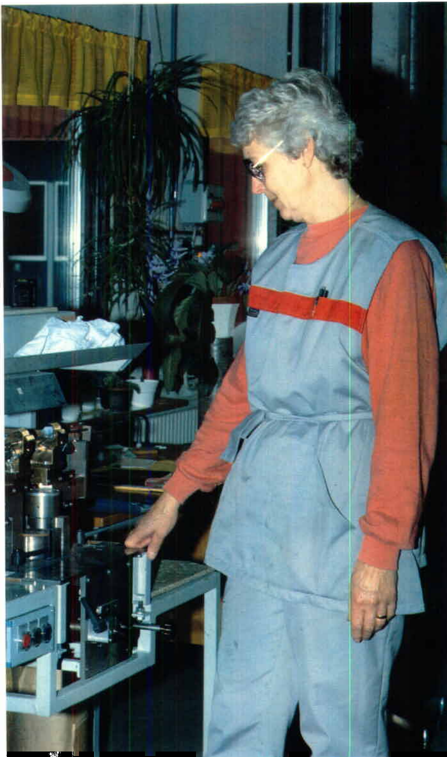
Gudrun Rydberg arbetar med bockning av Superelementen.
